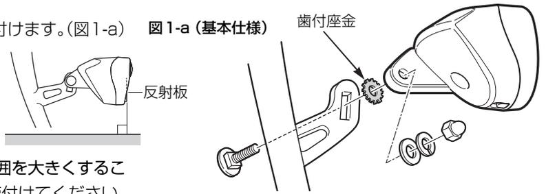
※ 別売の延長金具を使用するとライト取付位置の調整範囲を大きくすることができます。(図1-b) ネジ・ナット類は図のように締付けてください。
