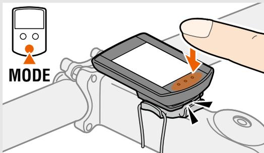
Lorsque l'ordinateur est monté sur le support, appuyez une fois sur la section point de l'unité, le bouton **MODE** est appuyé.
