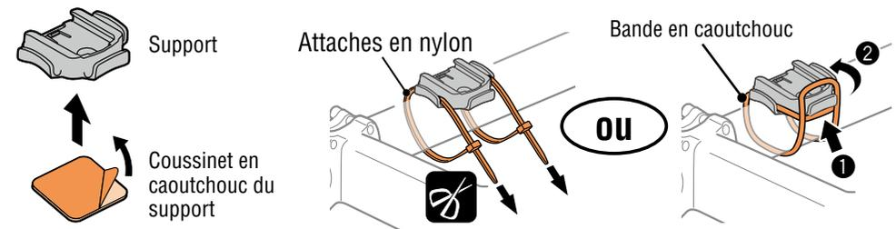
**Installez le support et l'aimant dans un endroit où les conditions d'installation sont remplies.**
