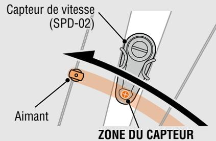
**C** L'intervalle entre la surface du capteur et l'aimant est égal ou inférieur à 5 mm.
