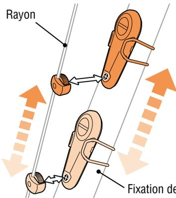
**Vérifiez la position de montage du capteur et de l'aimant**
