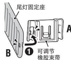
将可调节橡胶束带 (B) 安装在尾灯固定座 (A) 上。
