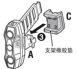
将支架橡胶垫 (C) 安装到尾灯固定座 (A) 背面。
