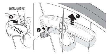
從輻條上方,將鎖緊用螺帽插入反光片後,再用硬幣類鎖緊固定。
