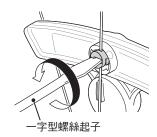
如欲拆卸反光片,請使用一字型螺 絲起子,以逆時針方向轉動的方式 鬆開鎖緊用螺帽。
