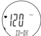
\*ID 同步化開始後，本裝置即會進入搜尋模式 5 分鐘。在搜尋模式下按 **SSS** 鈕可取消 ID 同步化，同時「**ID-SKIP**」會顯示。若在 5 分鐘內未能接收到任何的傳感器信號，「**ID-ERROR**」即會顯示。顯示「**ID-SKIP**」或「**ID-ERROR**」，即表示該 ID 未能正確同步化。
