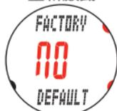
\* 按下 **MODE1** 或 **MODE2** 鈕選取「**YES**」（是），進行格式化作業。由於格式化作業會刪除所有資料，請選取「**NO**」（否），進行重新啟動作業。請參閱第 21 頁的「格式化／重新啟動操作」，瞭解格式化與重新啟動作業之間的差別。
