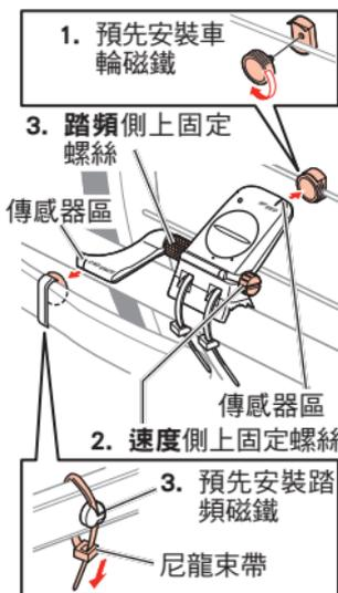
\*當速度傳感器未能正確定位而對應於兩個磁鐵（在步驟 2 和 3 中）時，請將速度傳感器來回移動，使其能正確定位。在您移動速度傳感器後，請適度調整位置，使兩個磁鐵能面向相關的傳感區。
