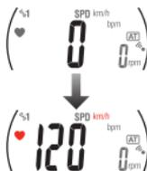
\* 心率傳感器亦可藉由用姆指摩擦兩塊電極墊加以啟動，此方法不能精確測量心率，但可作為測試傳感器／手錶通訊及搜尋傳感器 ID 的簡易方法。
