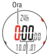
4. Selezionare il formato di visualizzazione della data. Selezionare il formato di visualizzazione della data tra "**YY.MM.DD**", "**DD.MM.YY**" e "**MM.DD.YY**" utilizzando i tasti **MODE1** e **MODE2**, quindi confermare con il tasto **SSS**.
