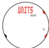
2. Selezionare l'unità di velocità premendo i tasti **MODE1** e **MODE2** e confermare con il tasto **SSS**.
