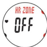
3. Selezionare la zona target frequenza cardiaca. Selezionare uno dei valori "OFF", "ZONE-1", "2", "3", "4" o "5" premendo i tasti **MODE1** o **MODE2**. Per impostare la zona target frequenza cardiaca, selezionare da "1" a "5" e confermare premendo il tasto **SSS**, e poi procedere al passo 4. Altrimenti, per andare al passaggio 6, selezionare "OFF".
