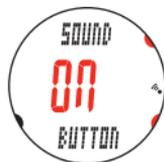
4. Selezionare **"ON"** o **"OFF"** per il suono dell'allarme della zona target frequenza cardiaca utilizzando il tasto **MODE1** o **MODE2**.
