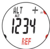
4. Selezionare "+" o "-" dell'altitudine del livello del mare. Quindi, cambiare ogni cifra singolarmente per il valore utilizzando i tasti **MODE1** e **MODE2** e spostarsi di cifra utilizzando il tasto **SSS**.
