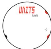
3. Selezionare l'unità della velocità utilizzando i tasti **MODE1** e **MODE2**.
