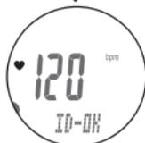
\* Questa unità passa nel modo di ricerca per 5 minuti dopo aver iniziato la sincronizzazione dell'ID. Premere il tasto **SSS** nel modo di ricerca per annullare la sincronizzazione e verrà visualizzato "ID-SKIP". Se non viene ricevuto alcun segnale dal sensore entro 5 minuti, viene visualizzato "ID-ERROR". La visualizzazione "ID-SKIP" o "ID-ERROR" indica che l'ID non è stato sincronizzato correttamente.
