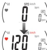
\* Il cardio-sensore può anche essere attivato strofinando ripetutamente entrambe le superfici degli elettrodi con i pollici. Tale metodo non può essere usato per misurare accuratamente il battito cardiaco, ma può essere usato come semplice metodo per testare la comunicazione fra il sensore e l'orologio da polso e per ricercare l'ID del sensore.
