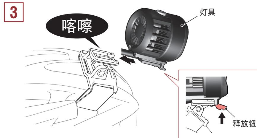
要拆下灯具主体时，应一边将灯具底面的释放钮往主体侧按压，一边往前拔出。
