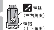
调整时,以支架可稍微移动的程度,松开螺帽或螺丝进行调整,最后再确实转紧固定。
