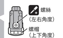
調整時,以支架可稍微移動的程度,鬆開螺帽或螺絲進行調整,最後再確實轉緊固定。
