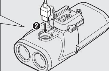
1. Conecte la unidad luminosa a su PC o a un cargador de batería USB disponible en el mercado mediante el cable USB. (1 – 2). El conmutador se ilumina y la carga se inicia.
