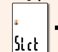
Przełączenie obwodu koła A/B
