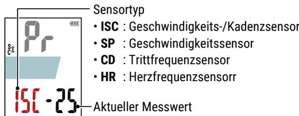
\* Wenn der angezeigte Sensor nicht der gewünschte ist, drücken und halten Sie **MODE**. Das Air GPS II startet die Sensorsuche erneut, ohne die Kopplung zu bestätigen.
