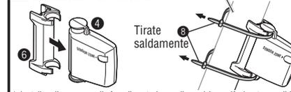
\* Installare il sensore sulla forcella anteriore nella posizione più elevata possibile.
